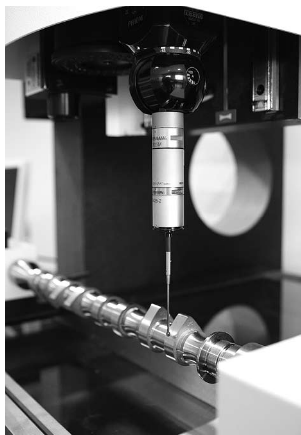
Измерение сканирующим контактным щупом Renishaw SP25
