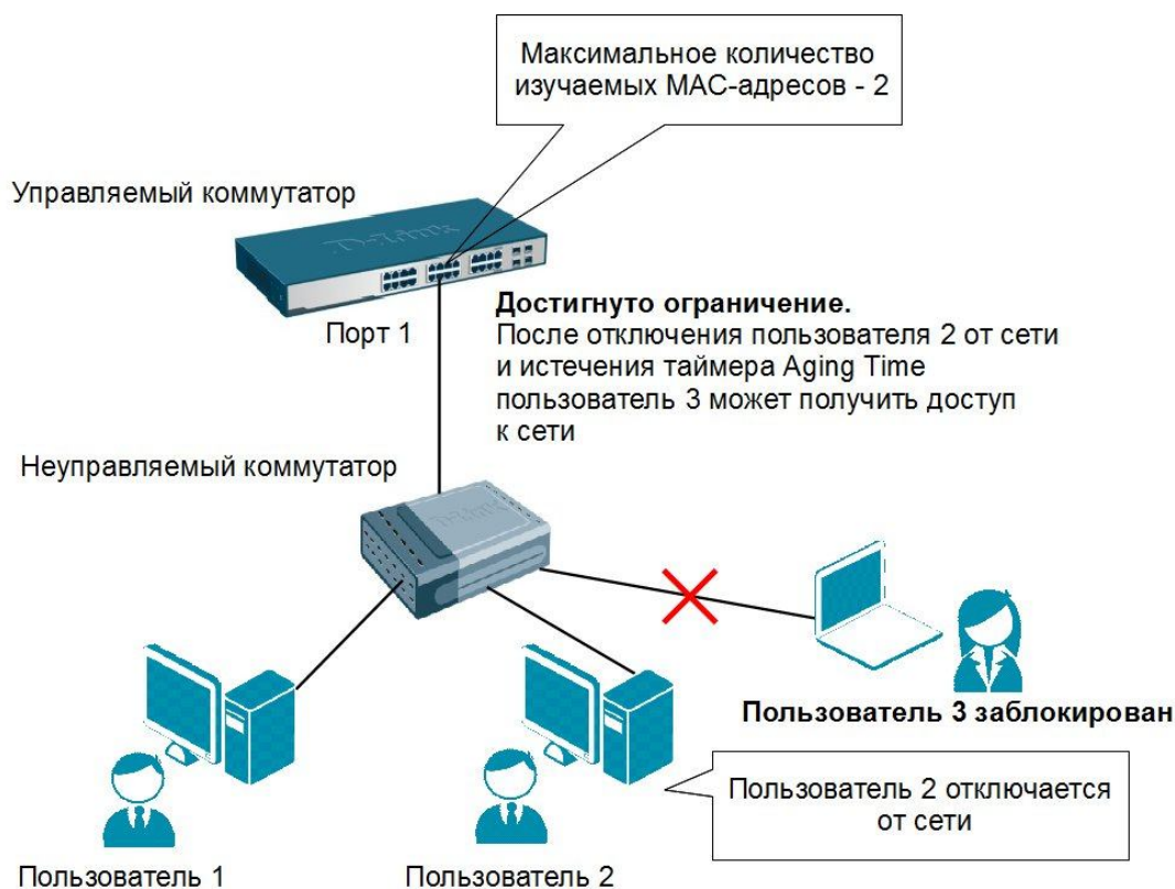
Рис. 7.7. Функция Port Security в режиме Delete on Timeout
