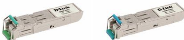
Рис. 1.10. Модули SFP DEM-331R и DEM-331T с 1 портом 1000BASE-BX10 с поддержкой технологии WDM
