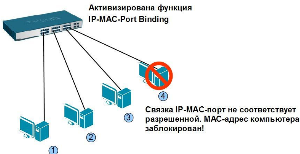
Рис. 7.8. Функция IP-MAC-Port Binding
