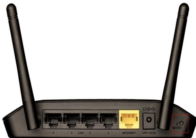
Рисунок 11.1 Расположение кнопки Reset на маршрутизаторе DIR-615
