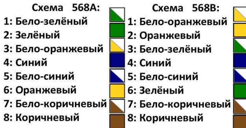
Рисунок 3.15 Распределение проводников в разъеме по стандартам EIA/TIA-568A и EIA/TIA-568B
