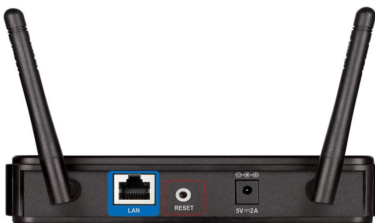
Рисунок 7.36 Расположение кнопки Reset на точке доступа DAP-2310
