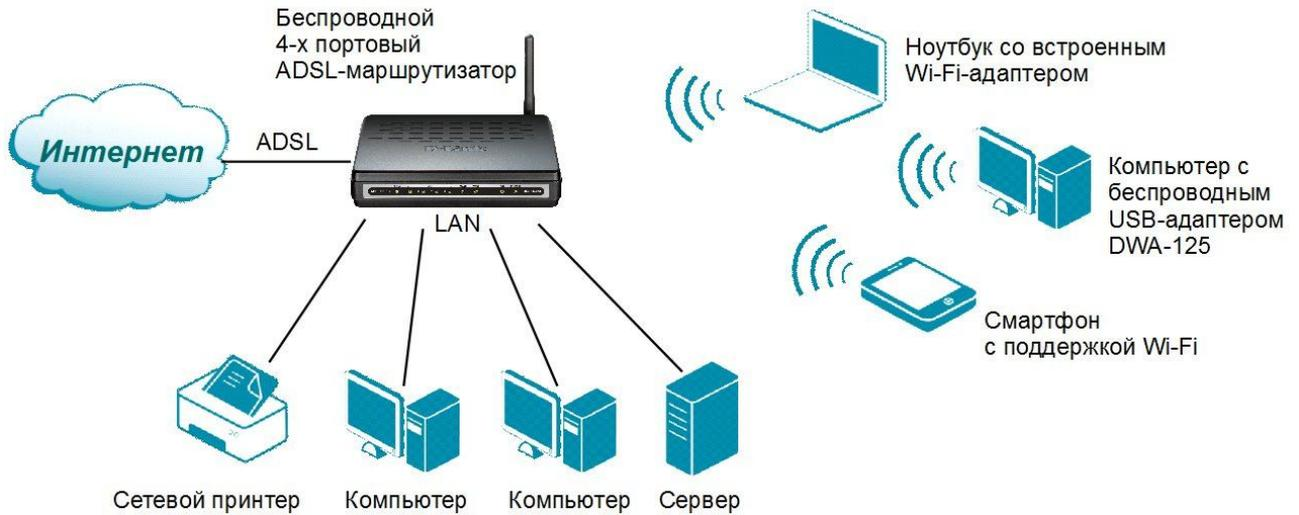
**Рис. 4.11** Подключение к Интернет с помощью Интернет-шлюза
