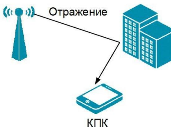
Рис. 3.71 Отражение электромагнитной волны
