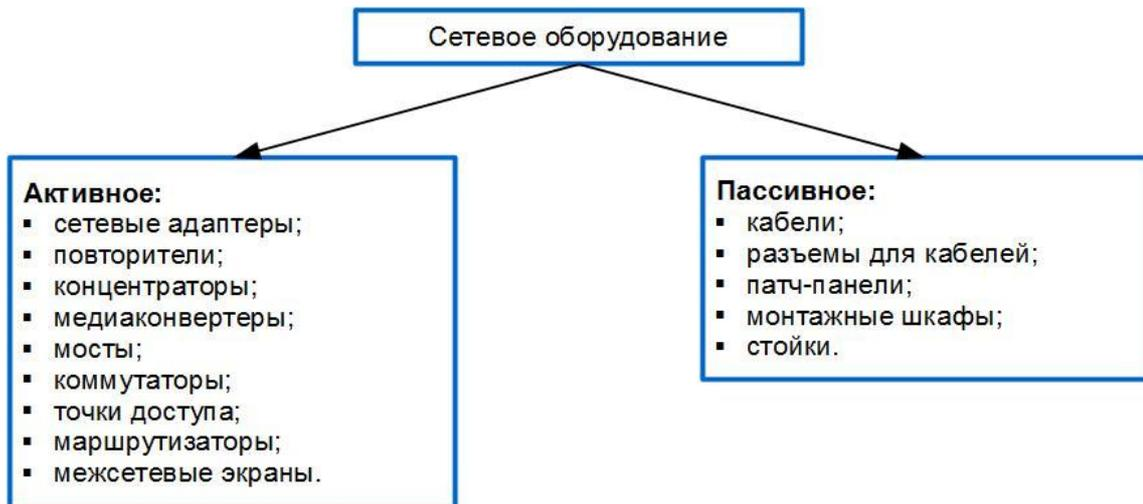
Рис. 3.57 Виды сетевого оборудования
