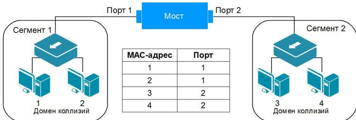
Рис. 4.4 Соединение двух сегментов сети с помощью моста
