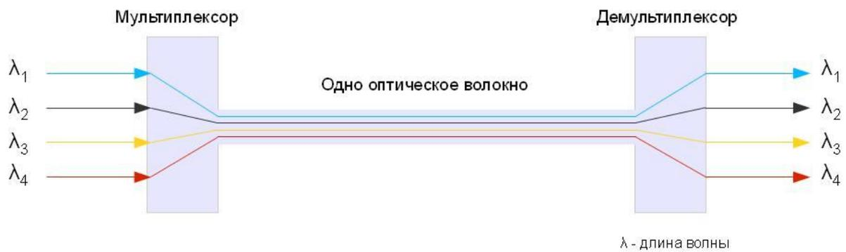
Рис. 3.19 Мультиплексирование со спектральным разделением
