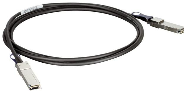
Рис. 3.35 Пассивный твинаксиальный кабель для прямого подключения с трансиверами QSFP+ длиной 3 метра
