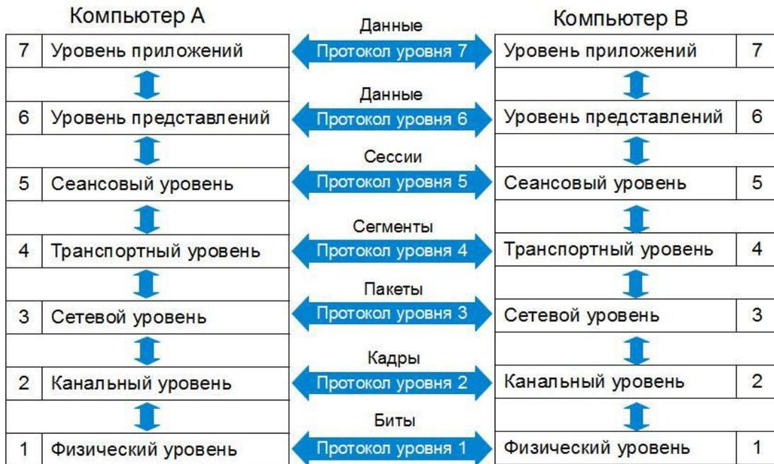
Рис. 2.4 PDU уровней модели OSI
