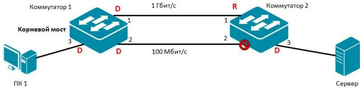
Рис. 6.15 Определение назначенных портов
