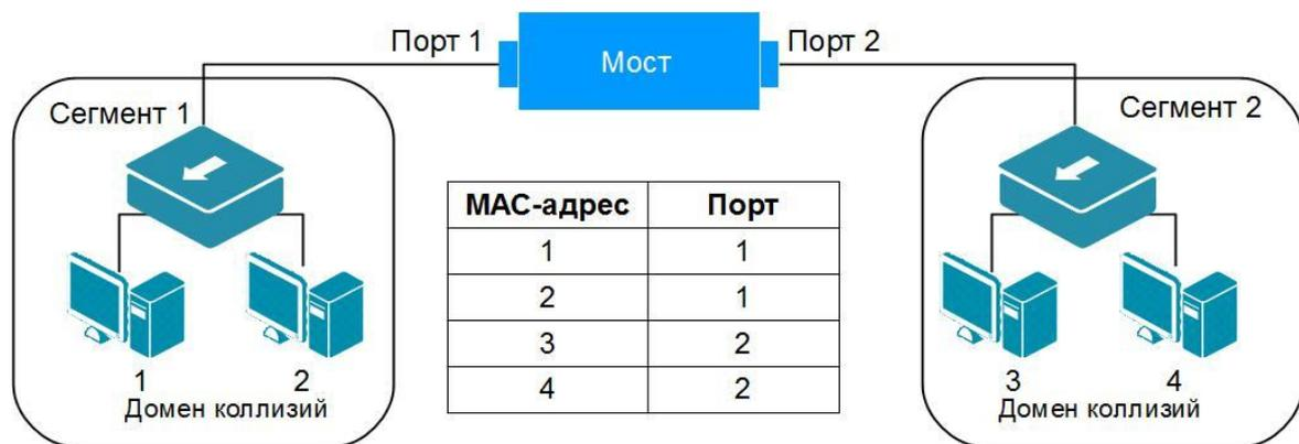
Рис. 5.25 Соединение двух сегментов сети в помощью моста
