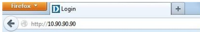
**Рис. 4.14** IP-адрес интерфейса управления по умолчанию в адресной строке Web-браузера
