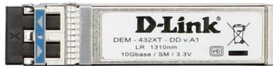
**Рис. 5.38** Модуль SFP+ DEM-432XT-DD с 1 портом 10GE (10GBASE-LR) для одномодового оптического кабеля и поддержкой функции цифровой диагностики
